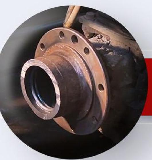
**CUT OFF DAMAGED SPINDLE 80MM FROM FLANGE**
